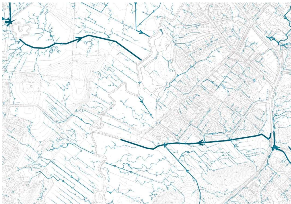
Kuva: Pintavalunta kaava-alueella ja sen ympäristössä. Aineisto on tuotettu Swecon 2023 tekemän hulevesiselvityksen aineistosta. Aineisto pohjautuu vuoden 2020 Maanmittauslaitoksen laserkeilausaineistoon. Paksulla sinisellä viivalla merkityillä ojilla on aineiston suurin yläpuolinen valuma-alue, joka on vähintään 800 000 m 2 .
